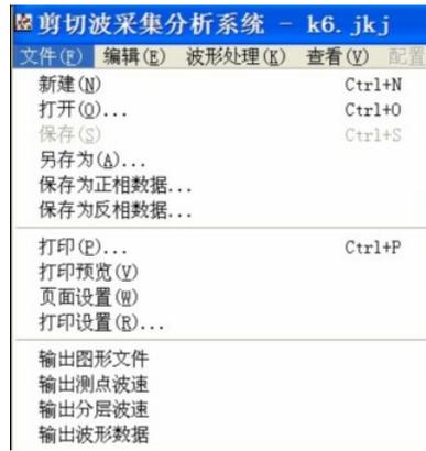
打开“文件”菜单的“输出图形文件”功能，可以使你的成果以图片的格式保存下里，然后在文档中使用插入图片功能就可以啦。
