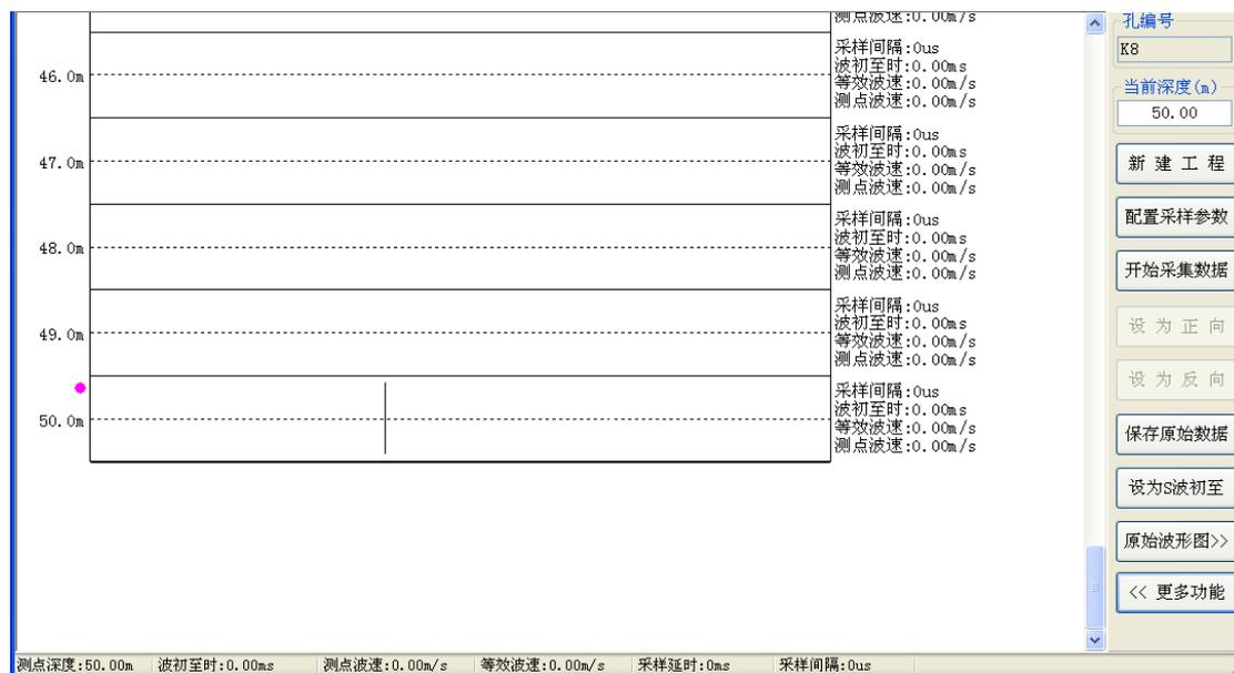
待激发人员现场准备好后，点击右侧“开始采集数据”按钮，激发人员从左侧锤击一次信号。此时屏幕自动显示采集到的原始信号曲线：
