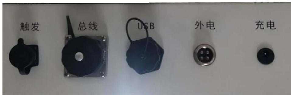
仪器背面是全部外组件的接线端口：外触发端口、电缆总线端口、USB 设备端口、外电以及充电端口。
